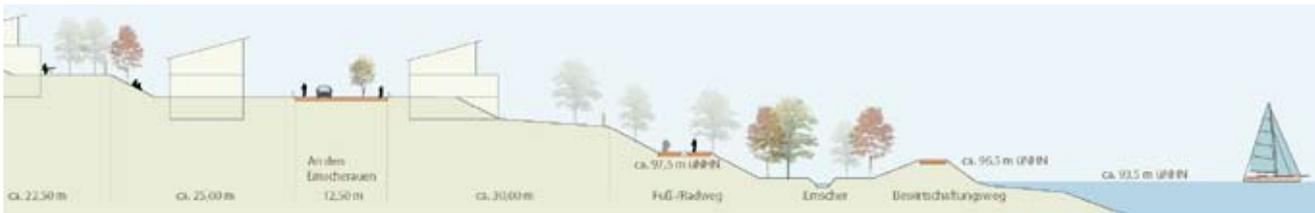
Südhang, schematischer Schnitt mit terrassierten Baufeldern, eingedeicherter Emscher-Trasse und See (Schnitt: pesch partner architekten stadtplaner)
